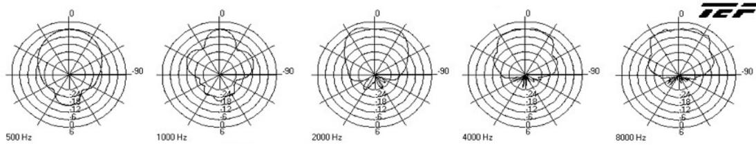
AH94-12T-BSG Horizontal Polars (Normalized To Zero On Axis) (- 6dB)
