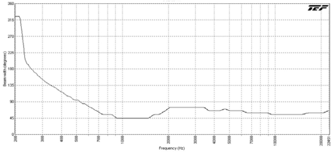
AH94-12T-BSG Vertical Beamwidth (-6dB)
