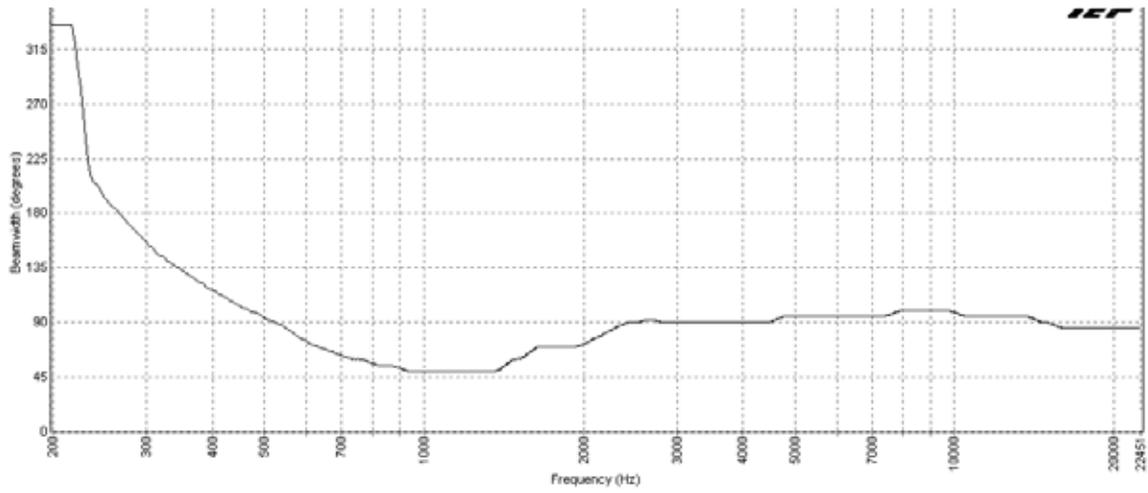
AH94-12T-BSG Horizontal Beamwidth (-6dB)
